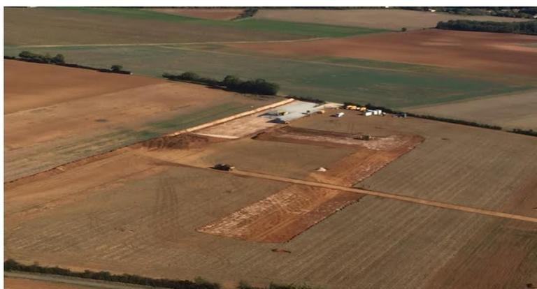
Dans les prochaines semaines, si tout continue ainsi, le chantier risque d'être progressivement excavé par une cohorte de tractopelles et verra ses environs quadrillés de 18 km de canalisations. Viendra enfin le pompage, 615m<sup>3</sup>/heure d'eau pompée pendant 45 jours 24h/24 pour arriver à l'une des plus grandes bassines construite en France avec pas moins de 720 000 m<sup>3</sup> d'eau stockée.
